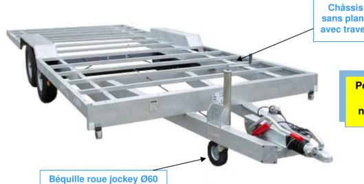
Châssis nu sans plancher avec traverses
