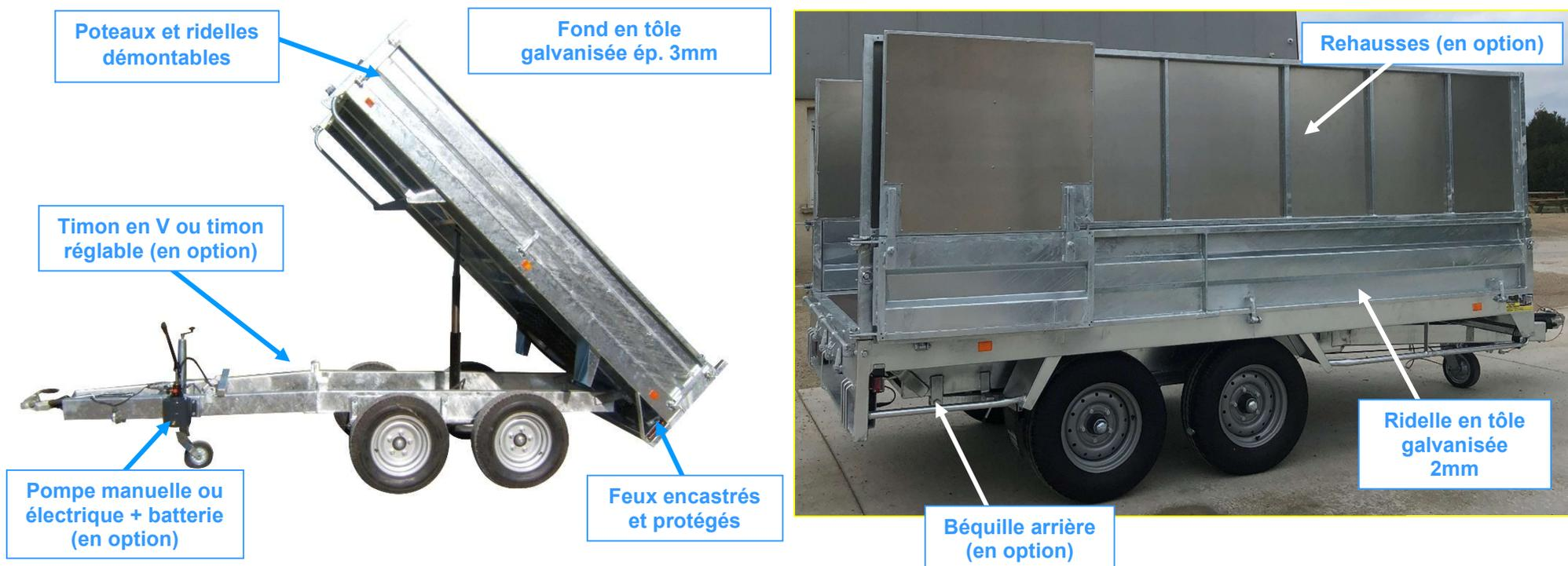
**Bennage par vérin télescopique 3 étages + pompe manuelle**
